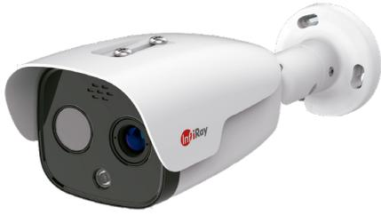
**Cámara térmica dual**, con sensor Micro bolómetro no refrigerado de 12  $\mu\text{m}$ , sensibilidad térmica (NETD) de  $\leq 40$  mK, cámara visible de 5 Mpx y resolución térmica 384x288 y 640x512.
