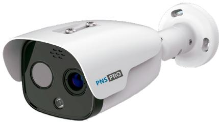
**Cámara térmica dual**, con sensor Micro bolometro no refrigerado de 12  $\mu\text{m}$ , sensibilidad térmica (NETD) de  $\leq 40$  mK, cámara visible de 5 Mpx y resolución térmica 384x288 y 640x512.
