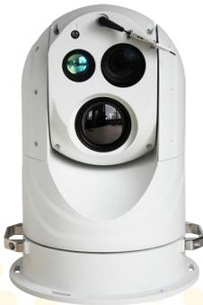
Cámara IP PTZ triple espectro, equipada con un avanzado detector térmico de 12 μm no refrigerado con una resolución de 640x512, óptica visible motorizada 4Mpx de 6.5 -240mm Zoom X37 y laser de 1500m.
